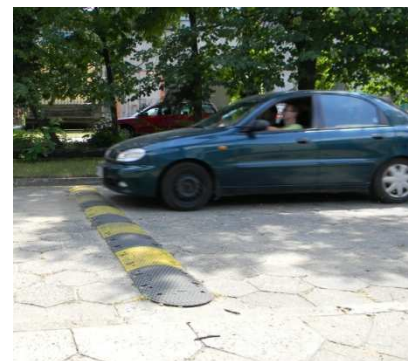
Rys. 8. Odcinek pomiarowy z umieszczonym „garbem.”
