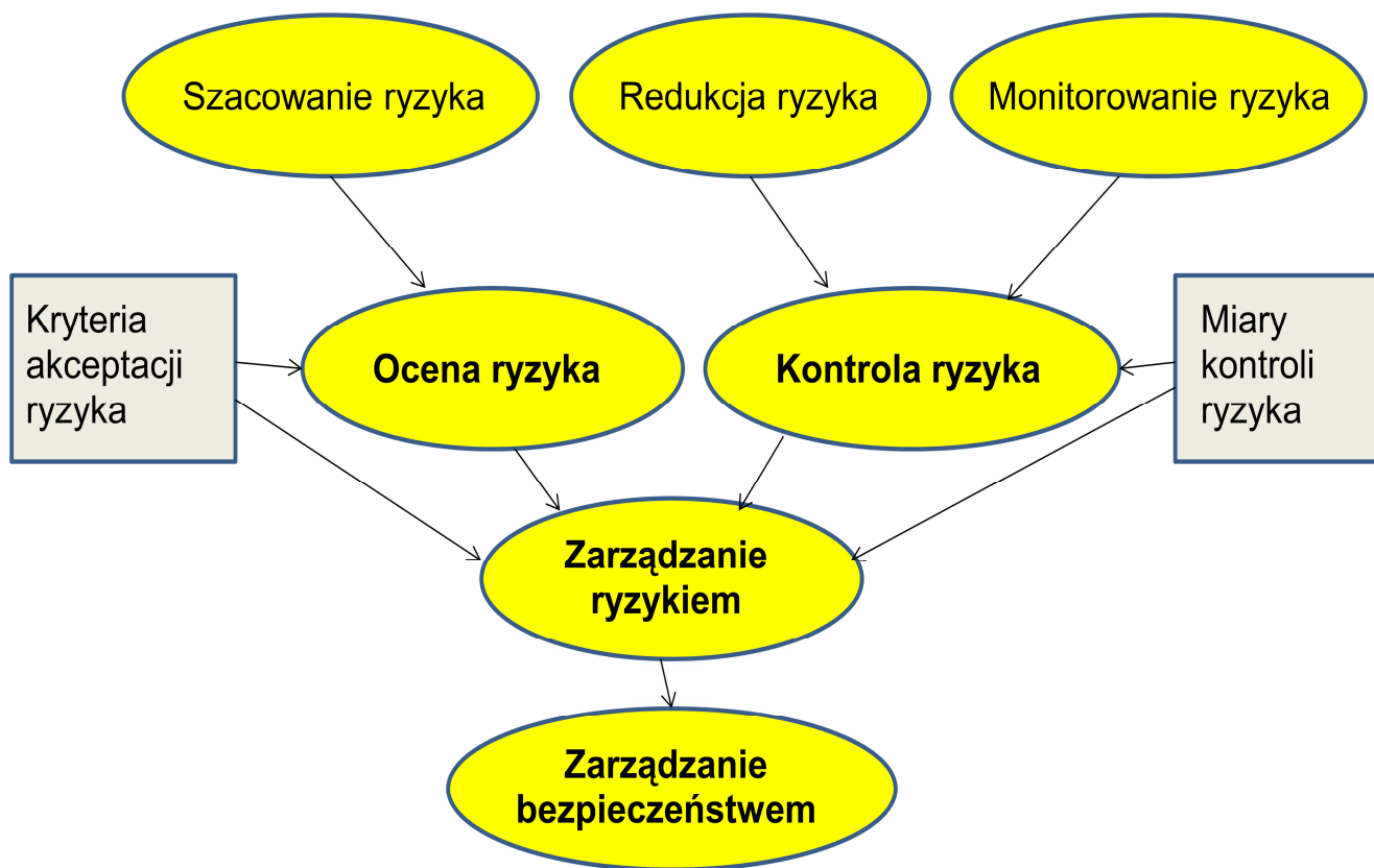
Rys. 7. Schemat zarządzania bezpieczeństwem statku w stanie uszkodzonym w omawianej metodzie. Źródło: opracowanie własne.
