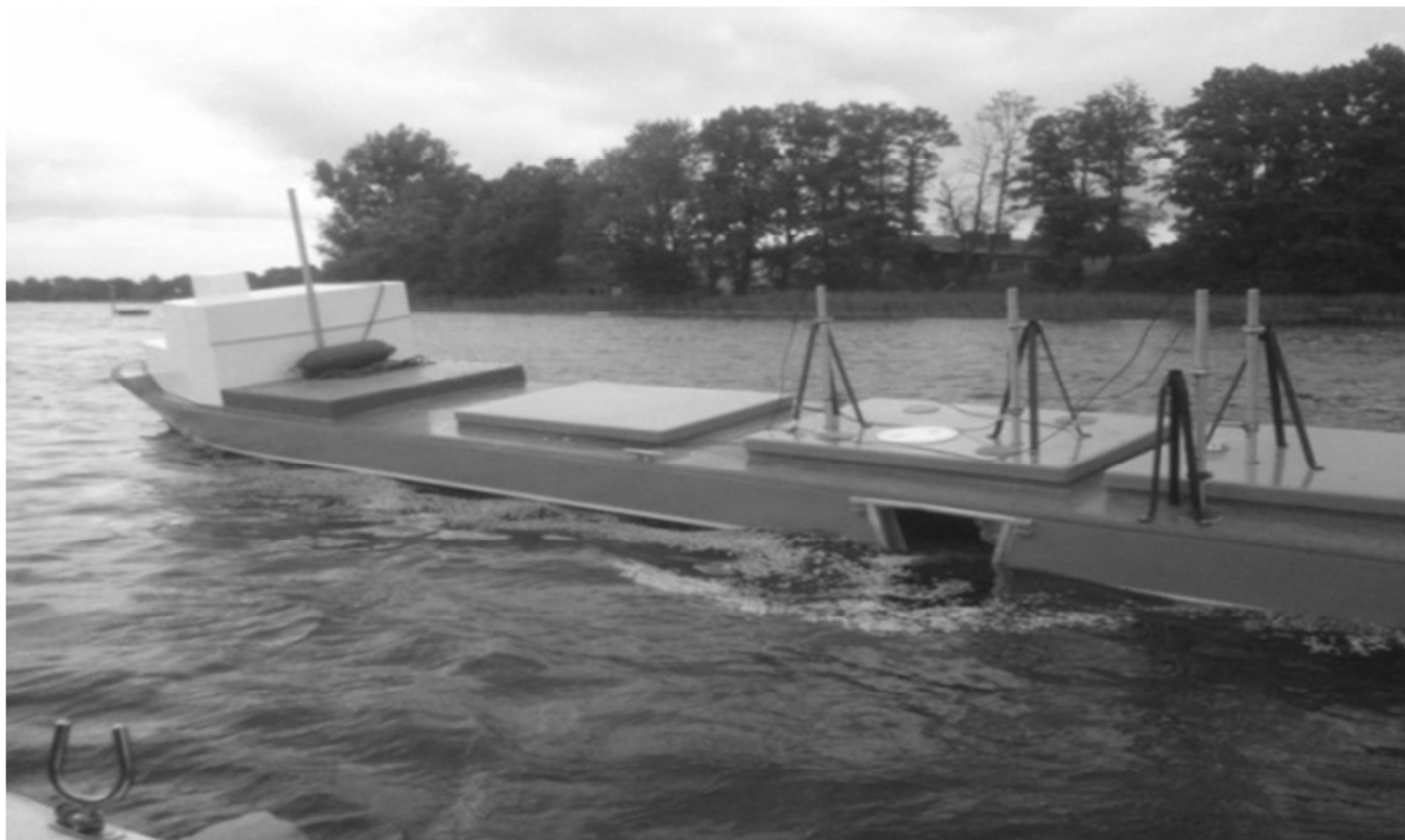
Rys. 3. Ilustracja badań zatapiania dużego modelu zbiornikowca.
