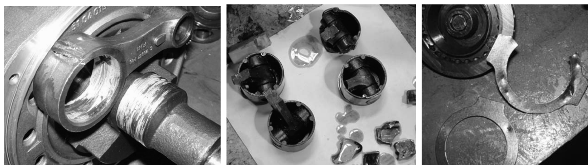
Rys. 5. Uszkodzone elementy sprężarki na skutek rozruchu zalanej sprężarki [8]
