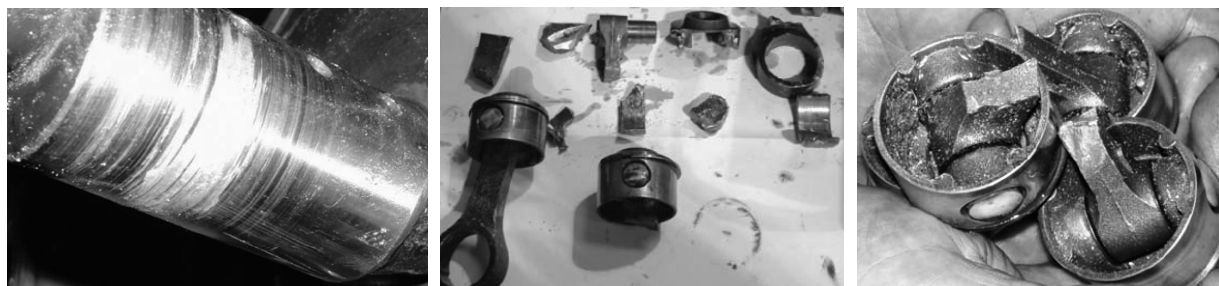
Rys. 4. Uszkodzone elementy sprężarki najprawdopodobniej na skutek zalewania sprężarki ciekłym czynnikiem [7]
