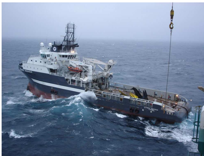
Rys. 5. Holownik AHV „Olympic Pegasus” w czasie rozwieszenia kotwicy [13]
