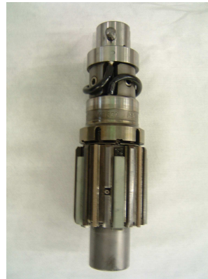
Rys.1. Głowica do honowania podstawowego wyposażona w głowicę z płytkami diamentowymi i głowica do honowania wykańczającego wraz z obróbką końcową, wyposażona w głowicę z płytkami diamentowymi i ceramicznymi
