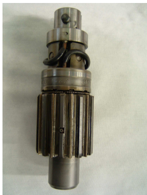
Rys.1. Głowica do honowania podstawowego wyposażona w głowicę z płytkami diamentowymi i głowica do honowania wykańczającego wraz z obróbką końcową, wyposażona w głowicę z płytkami diamentowymi i ceramicznymi
