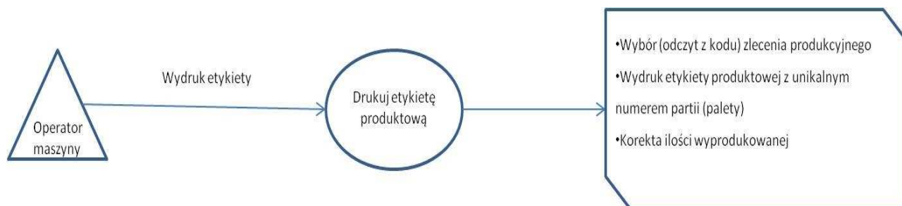
Rys. 2. Schemat blokowy procedury „Emisja Etykiet Produktowych”
