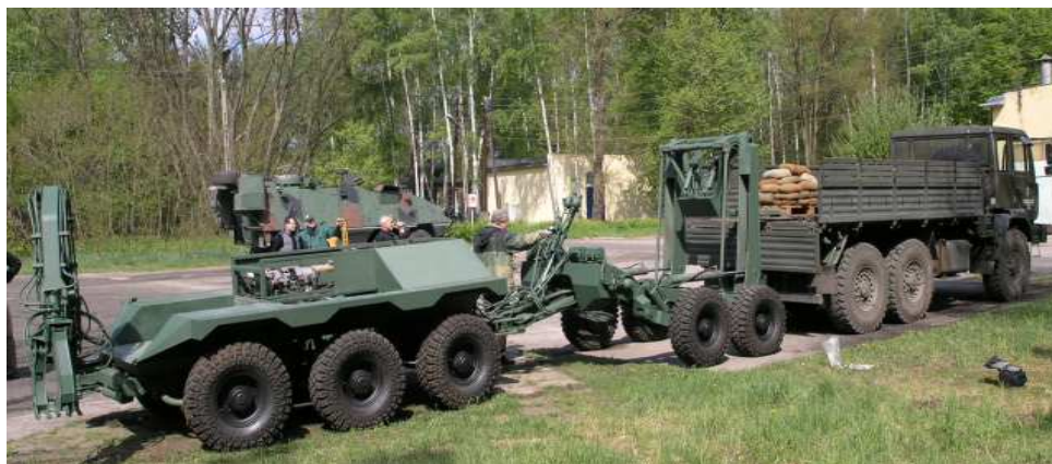
Rys. 5. Podejmowanie ładunku osprzętem widłowym tylnego członu platformy bezzałogowej z przestrzeni transportowej samochodu ciężarowego [4]
