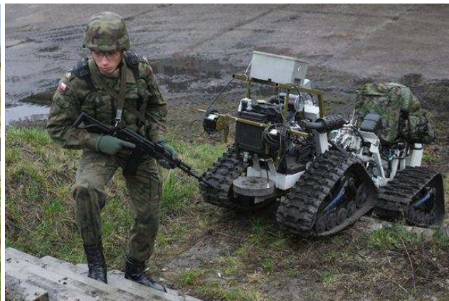
Rys. 8. Platforma wsparcia drużyny „Dromader”: a - pokonywanie schodów; b – podążanie za żołnierzem [1]
