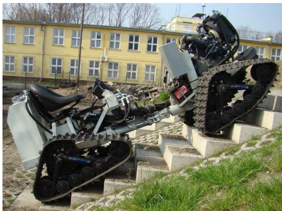
Rys. 8. Platforma wsparcia drużyny „Dromader”: a - pokonywanie schodów; b – podążanie za żołnierzem [1]
