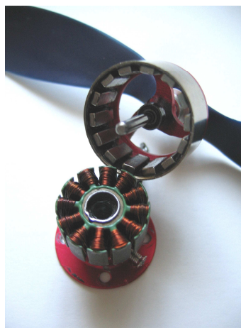
Rys. 2. Bezszytkowy silnik prądu stałego (BLDC) przeznaczony do sterowania beczujnikowego z wykorzystaniem sprzężenia zwrotnego od EFS nieaktywnej fazy
