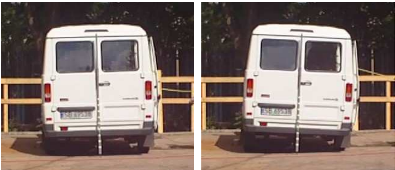
Rys. 7. Pomiar sztywności kątovej zawiesz
