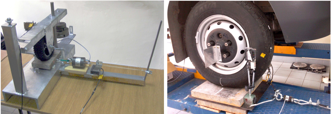
Rys. 6. Pomiar charakterystyk statycznych opon mobilnego modelu i rzeczywistego pojazdu
