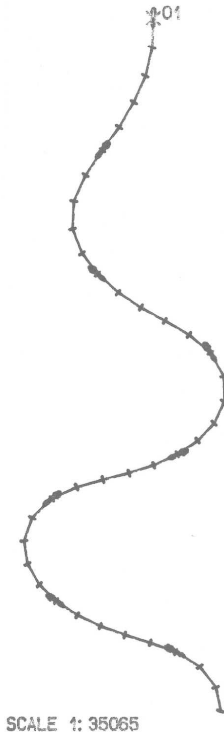
Rys. 7. Otrzymana podczas badań symulacyjnych trajektoria zmodyfikowanego modelu drobnicowca wykonującego próbę węzową, najbardziej zbliżona do wykresu trajektorii w czasie próby węzowej statku „Bonny“ (wydruk z symulatora)
