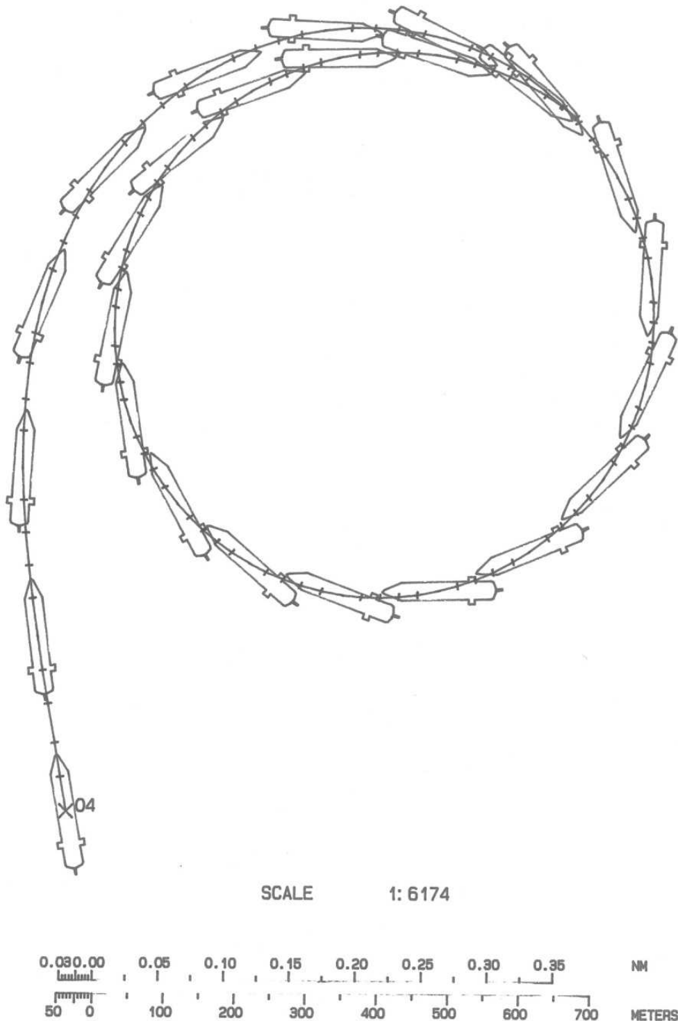
Rys. 6. Otrzymana w czasie badań symulacyjnych krzywa cyrkulacji modelu drobnicowca 2 najbardziej zbliżona do rzeczywistej krzywej cyrkulacji statku „Bonny”(wydruk z symulatora)
