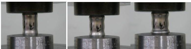
Rys.2. Widoki nieskorodowanej próbki podczas ściskania.
