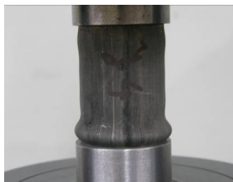
Rys. 3. Widok skorodowanej próbki w 20% kwasie siarkowym podczas próby ściskania.
