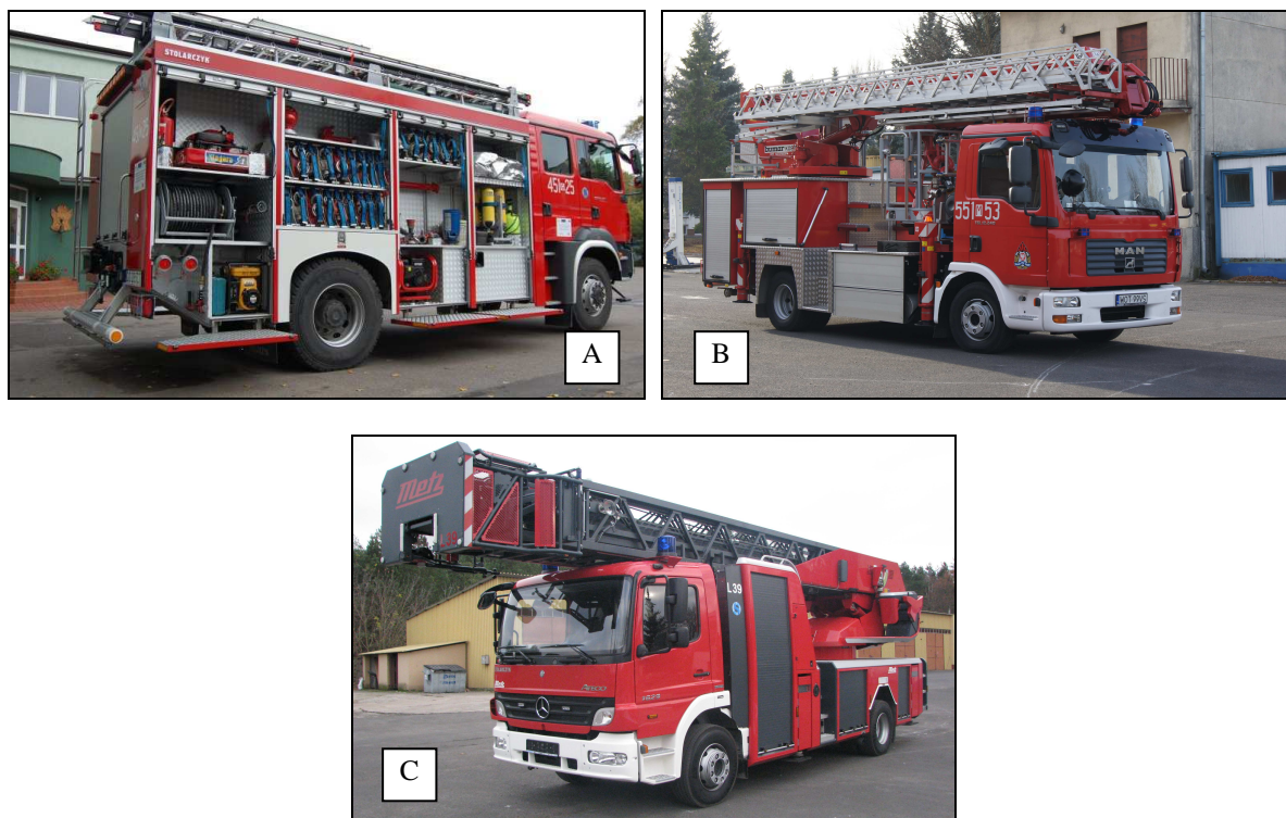
Rys. 1. A - samochód ratowniczo-gaśniczy, B – podnośnik pożarniczy, C - samochód z drabiną automatyczną
