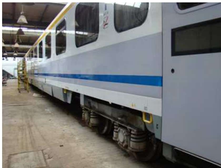
Rys. 10. Wyremontowany pasażerski wagon kolejowy PKP umieszczony na tymczasowych warsztatowych zespołach kołowych. [fot. autora]
