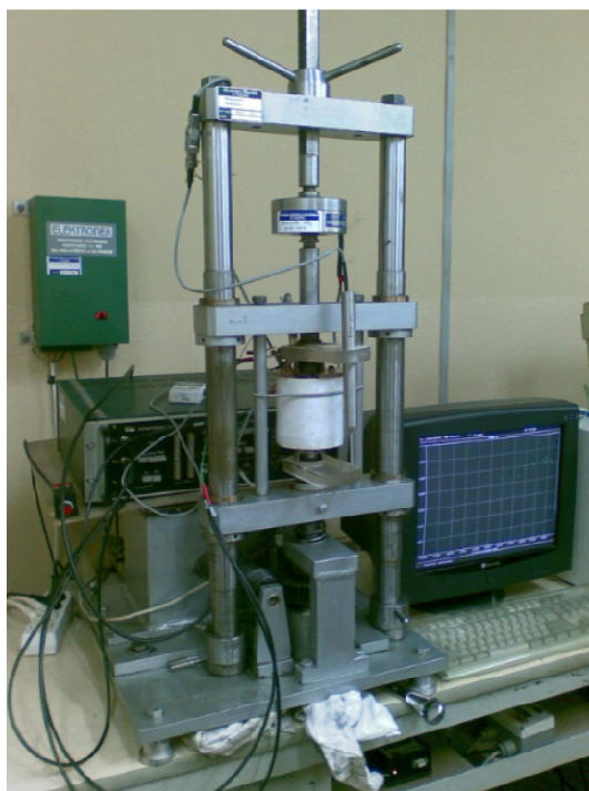
Rys. 4. Stanowisko do przeprowadzania badań nad odpornością korozyjno – naprężeniową z komputerowym zapisem siły rozciągającej i odkształcenia.
