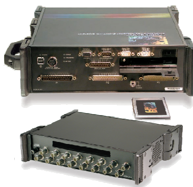
Rys. 5. System akwizycji danych LogBook 360 wraz z modulem wejść analogowych DBK 214 [9]
