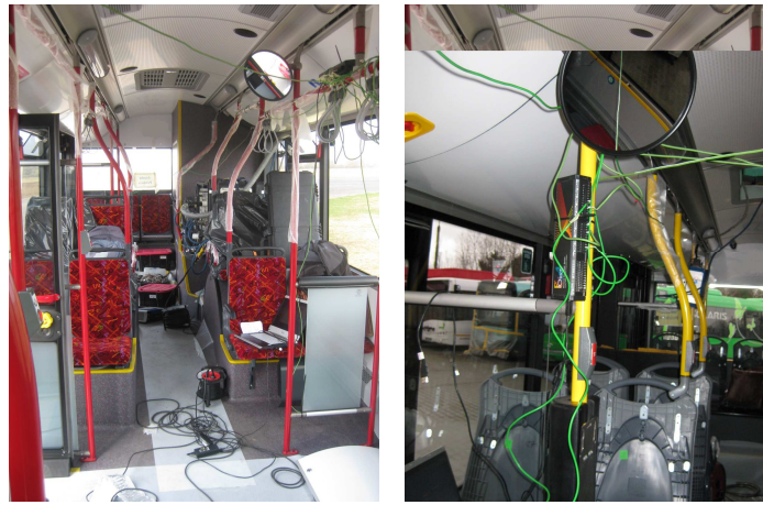
Rys.7. Widok wnętrza autobusu wraz z zamontowanym modulem zbiorczym pomiaru temperatury
