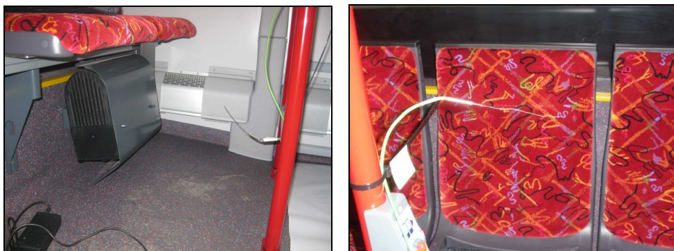
Rys.8. Termopary służące do określania wartości temperatury panującej we wnętrzu badanych autobusów
