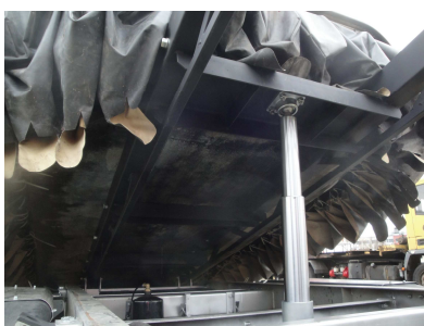
Rys. 7. Naczepa PIMR-N1/PNN z całkowicie wysuniętym teleskopowym trzysekcyjnym siłownikiem hydraulicznym
