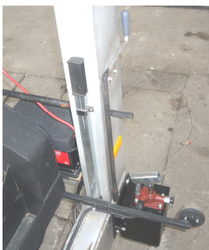
Rys. 9. Naczepa PIMR-N1/PNN – pompa hydrauliczna teleskopowego siłownika, wspornik wysuwny prawego białego światła postojowego, na kolumnie dyszla zamocowana dźwignia pompy oraz korba napędu wysuwnej podpory, z tyłu widoczny akumulator
