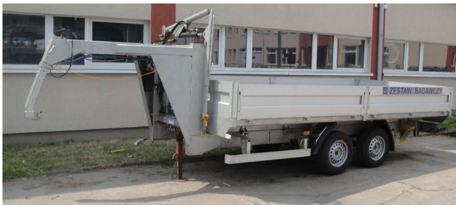
Rys. 3. Naczepa PIMR-N1 - w opcji ze składanym żurawikiem hydraulicznym do rozładunku kontenerów z sadzonkami drzewek leśnych
