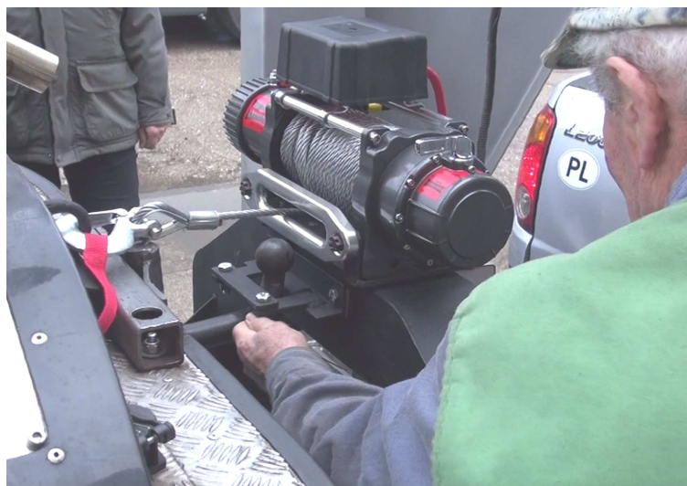
Rys. 10. Naczepa PIMR-N1/PNN – rama wsporcza z zamocowaną wyciągarką elektryczną, pod liną z hakiem znajduje się uchwyt dla zablokowania zaczepu kadłuba PNN
