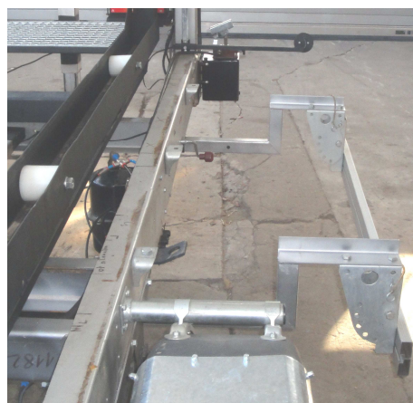
Rys. 11. Naczepa PIMR-N1/PNN – sposób mocowania zaczepu dla pasa ściągającego do mocowania kadłuba PNN, wspornik wysuwnej profilu ochronnego, z tyłu korba hamulca postojowego i wspornik wysuwny białego światła postojowego
