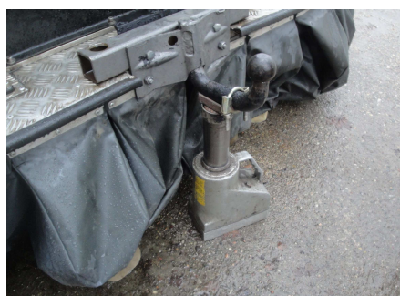
Rys. 13. Uniesienie kadłuba PNN przy użyciu podnośnika hydraulicznego celem jego załadunku na rampę naczepy, na zaczepie zamocowana klamra zabezpieczająca kolumnę podnośnika przed jej przypadkowym wysunięciem
