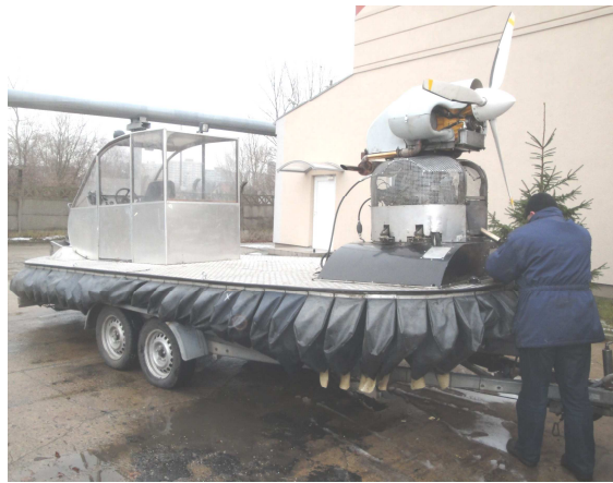
Rys. 2. Przyczepa samochodowa z PNN – bez poprawnego oznakowania światłami pozycyjnymi i odblaskowymi
