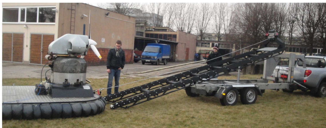
Rys. 12. Naczepa PIMR-N1/PNN - z rampą w położeniu do załadunku, z hakiem zaczepionym o kadłub PNN i z pracującym silnikiem zespołu do wytwarzania poduszki powietrznej
