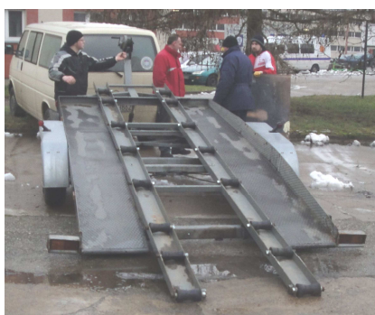
Rys. 1. Przyczepa samochodowa z dodatkowo prowadnicami i rolkami
