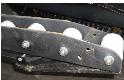
Rys. 8. Naczepa PIMR-N1/PNN – widok płyty podporowej oraz sposobu rozmieszczenia rolek na końcu prowadnicy, widoczne otwory służą do mocowania belki tylnej z tablicą rejestracyjną i światłami
