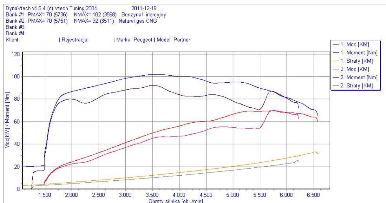
Rys. 3. Porównanie osiągnięć silnika na benzynie i CNG
