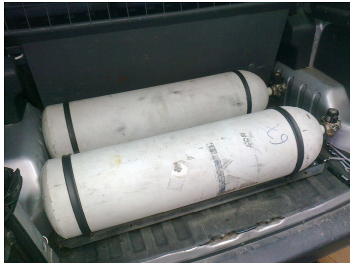
Rys. 4. Zbiorniki CNG zamontowane w pojeździe
