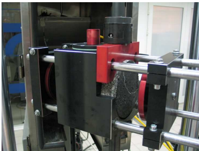
Fot.1. Aparat do ścinania próbek z możliwością przyłożenia siły bocznej
