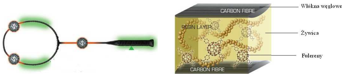
Rys. 8. Przekrój poprzeczny trzonka rakiety do badmintonu, wykonanej z nowoczesnych materiałów [http://www.yonex.com/badminton/webcatalog2011/#page=15]
