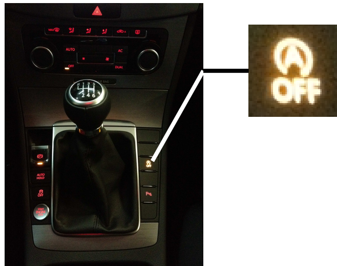
Rys. 3. Położenie przycisku funkcji Start-Stop VW Passat
