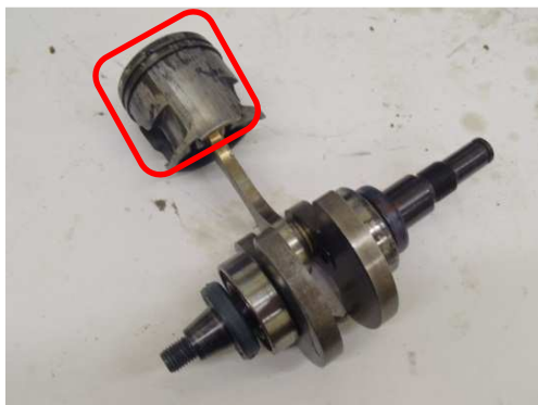
Rys.6. Zatarcie tłoka w cylindrze pilarki: a) widok płaszcza tłoka, b) widok tulei cylindrowej od strony kanałów wydechowych
