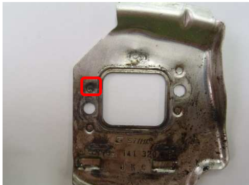
Rys.8. Metalowa przysłona termiczna układu wydechowego: a) widok ogólny, b) miejsce nieszczelności x10
