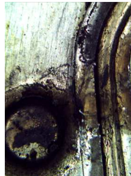
Rys.8. Metalowa przysłona termiczna układu wydechowego: a) widok ogólny, b) miejsce nieszczelności x10
