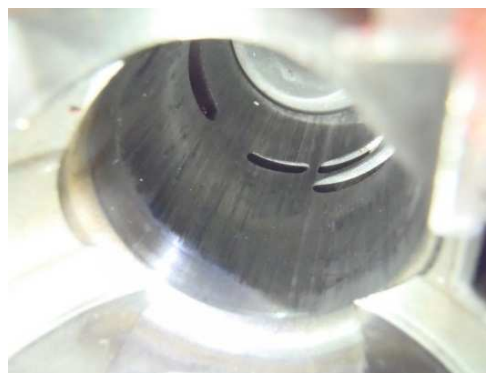
Rys.6. Zatarcie tłoka w cylindrze pilarki: a) widok płaszcza tłoka, b) widok tulei cylindrowej od strony kanałów wydechowych
