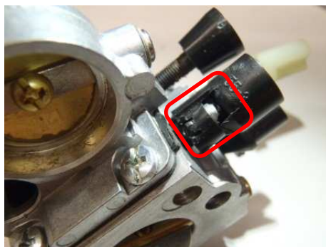
Rys.7. Przepustnica gaźnika i śruby regulacji składu mieszanki (widoczne zerwane zabezpieczenie śruby regulacyjnej)
