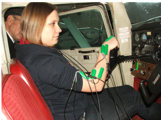
Rys. 5. Rozmieszczenie przetworników dla badania goniometrycznego i metody RULA dla pozycji 3 (a) i 4 (b) w samolocie Cessna 150
