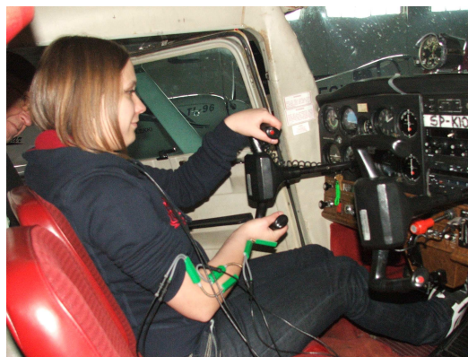
Rys. 5. Rozmieszczenie przetworników dla badania goniometrycznego i metody RULA dla pozycji 3 (a) i 4 (b) w samolocie Cessna 150
