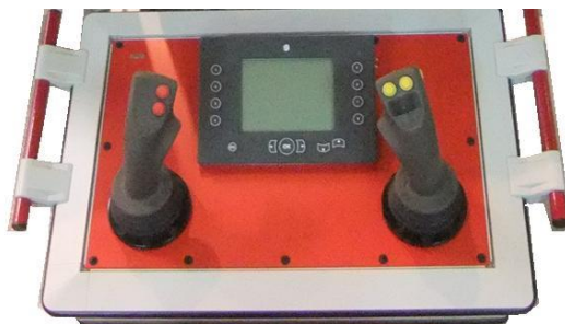
Rys. 14. Panel sterujący zamontowany na stanowisku sterowania
