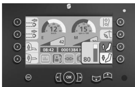
Rys.15. Wyświetlacz DP600 firmy Danfoss zastosowany do wyświetlania podstawowych parametrów [12]
