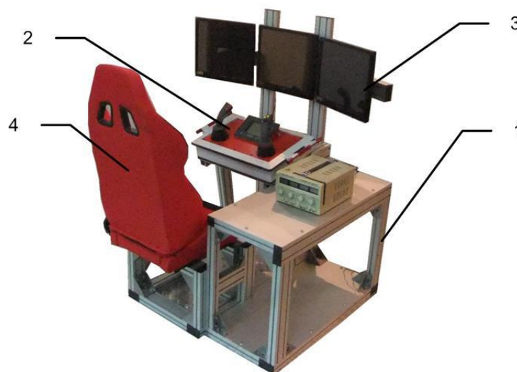
Rys.20. Stanowisko zdalnego sterowania: 1- konstrukcja z profili aluminiowych, 2-panel sterujący, 3- zestaw monitorów, 4-fotel operatora.
