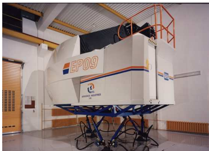
Rys. 2. Ruchomy symulator jazdy lokomotywą EP09 [5]
