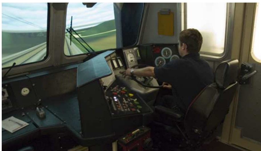
Rys. 5. Wnętrze symulatora odzwierciedlającego lokomotywę EP09 [7]
