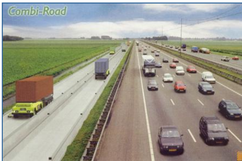
Rys. 3. Zautomatyzowany system transportu kontenerów- system AGV Źródło: COMBI-ROAD An Innovation in Large Scale Container Transport
