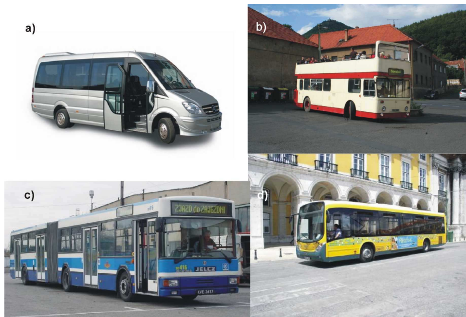
Rys.3 Przykłady nadwozi autobusów miejskich [materiały własne]; a) zakryte, b) odkryte, c) wagonowe przegubowe, d) wagonowe
