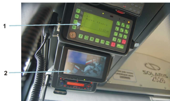
Rys. 7 Monitoring wizyjny przestrzeni pasażerskiej w kabinie kierowcy autobusu[8]; 1 – pulpit kontrolno sterowniczy, 2 – monitor systemu nadzoru
