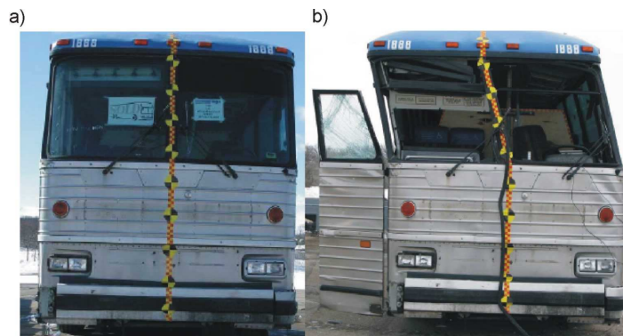
Rys. 5 Przykład badań nadwozia autobusu wykonanych wg testu ECE R-66[4]; a – przed testem, b – po teście z widocznym odkształceniem części pasażerskiej nadwozia autobusu
