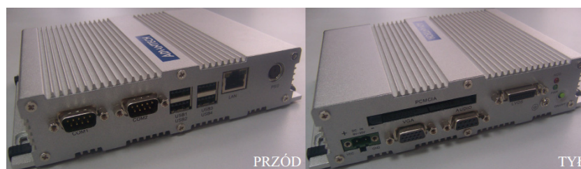
Rys. 3. Wygląd prototypu IMK wykorzystującego płytę Advantech ARK1380
