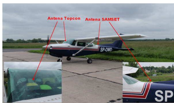
Rys. 4. Rozmieszczenie anten GNSS podczas lotów testowych
