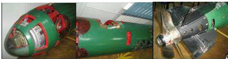
Fot. 1. Torpeda SET 53 z przekrojami w IUO AMW
