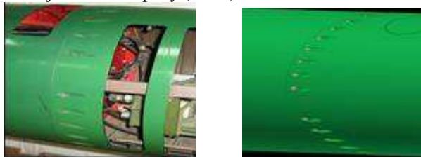
Fot. 2. Połączenie korpusu torpedy z głową bojową
