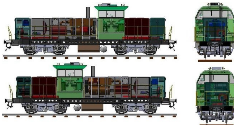
Rys.5 Widok ogólny lokomotywy – rozmieszczenie maszyn i urządzeń
