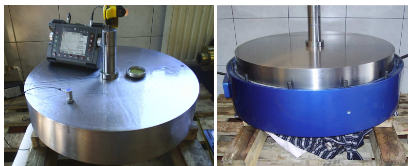
Rys. 3. Widok koła zamachowego wraz z wałem podczas badań defektoskopowych oraz umieszczenia w obudowie
