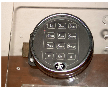
Rys. 5. Zamek szyfrowy elektroniczny typ 6124 firmy Sargent & Greenleaf, widok z przodu (a), widok wnętrza z tyłu (b)
