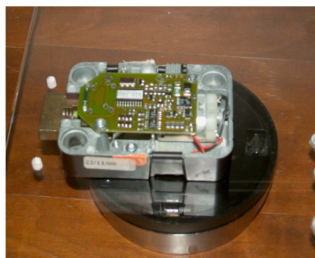
Rys. 5. Zamek szyfrowy elektroniczny typ 6124 firmy Sargent & Greenleaf, widok z przodu (a), widok wnętrza z tyłu (b)
