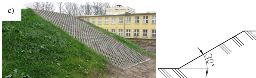
Rys.3. Zdjęcia poglądowe i przekroje poprzeczne zboczy pochylonych pod kątem: a) 18^\circ , b) 23^\circ , c) 30^\circ
