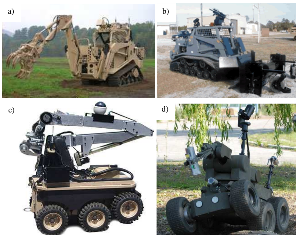
Rys.2. Przykłady rozwiązania Inżynierskich Robotów Wsparcia: a) RC 50 Robotic Platform, b) ARTS, c) robot LandShark, d) robot IBIS
