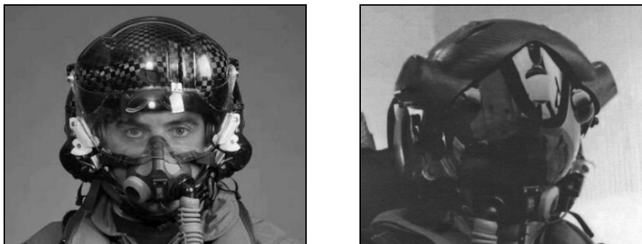
Rys.3. Przykładowe wyświetlacze danych dla systemu zobrazowania nahałmowego samolotu F-35 (po lewej) oraz wizja futurystyczna (po prawej)
