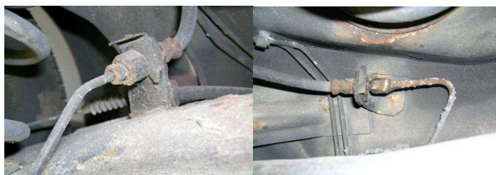
Rys. 3. Skorodowana końcówka montażowa – po lewej, uszkodzony przewód hamulcowy – po prawej
