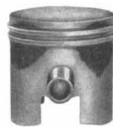
Ślady pracy uszkodzonych pierścieni
