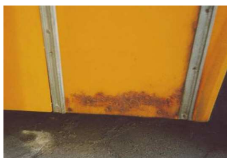
Rys. 5. Skorodowany element poszycia autobusu miejskiego
