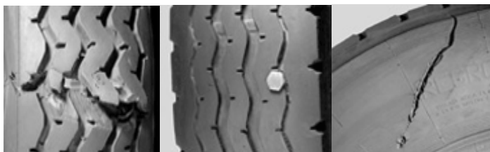
Rys. 4. Uszkodzenia opon: a) Pęknięcie warstw osnowy oraz opasania stalowego wskutek uderzenia w ostrą przeszkodę, b) Uszkodzenie mechaniczne czoła bieżnika opony, wskutek najechania na ciało obce (śrubę), c) Mechaniczne uszkodzenie warstw osnowy na boku opony, wskutek gwałtownego uderzenia w przeszkodę
