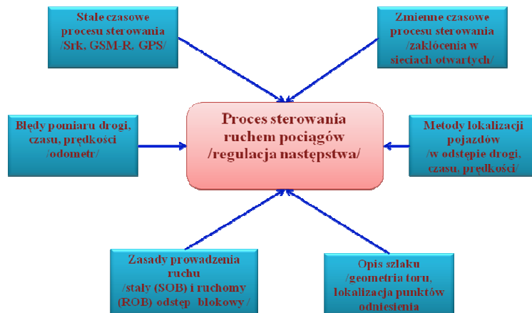
Rys. 4. Czynniki wpływające na proces sterowania ruchem pociągów
