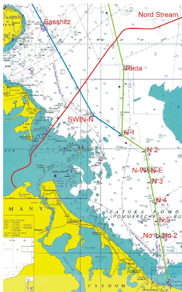
Rys. 4. Podejściowe tory wodne do portu Świnoujście z naniesionym planowanym gazociągiem Nord Stream
