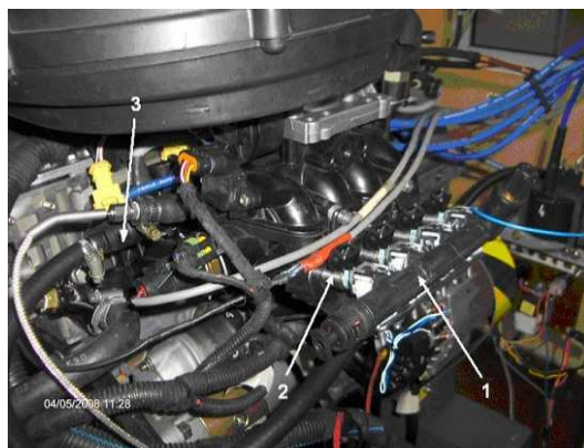
Fig. 9. Widok stanowiska badawczego: 1 – prototypowa szyna paliwowa, 2 – wtryskiwacz dodatkowy, 3 – oryginalna szyna paliwowa
