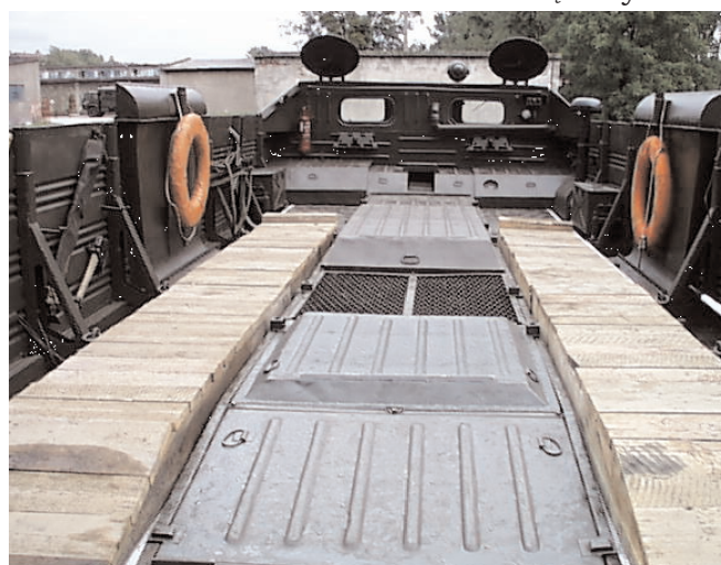
Rysunek 4. Niektóre z elementów adaptacyjnych transportera PTS dla potrzeb realizacji zadań ewakuacji ludności, inwentarza, pojazdów i urządzeń
