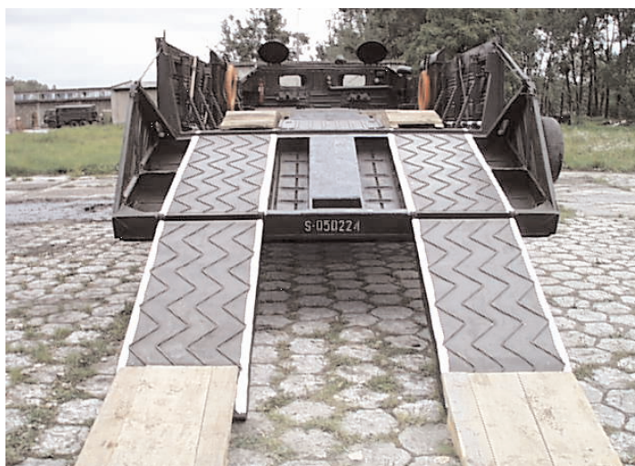
Rysunek 4. Niektóre z elementów adaptacyjnych transportera PTS dla potrzeb realizacji zadań ewakuacji ludności, inwentarza, pojazdów i urządzeń
