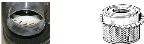
Rys. 13. Monocyklon: a) zamocowany do obudowy filtra powietrza, b) stanowiący całość z wkładem filtracyjnym
