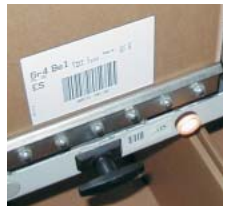
Fot. 7. Sygnał świetlny informujący o prawidłowym zrealizowaniu czynności kompletacji. Źródło: Prezentacja firmy STILL
