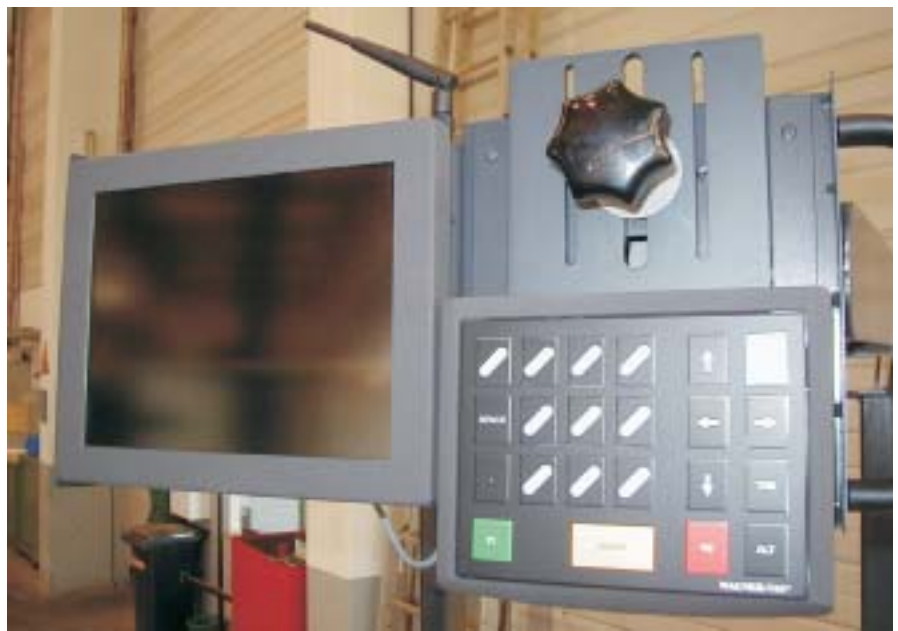
Fot. 4. Układ komunikacyjny zintegrowanego systemu obsługi z ciekłokrystalicznym monitorem ekranowym. Źródło: Prezentacja firmy STILL
