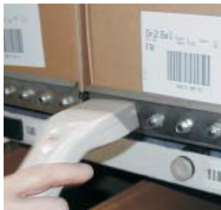
Fot. 6. Identyfikacja opakowania zbiorczego i pola odkładczego z systemem MMS. Źródło: Prezentacja firmy STILL
