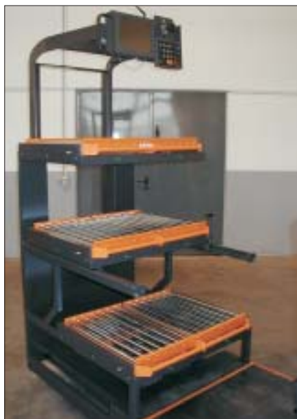
Fot. 1. Osprzęt do wózka jezdniowego podnośnikowego kompletacyjnego typu EK 10. Źródło: Prezentacja firmy STILL
