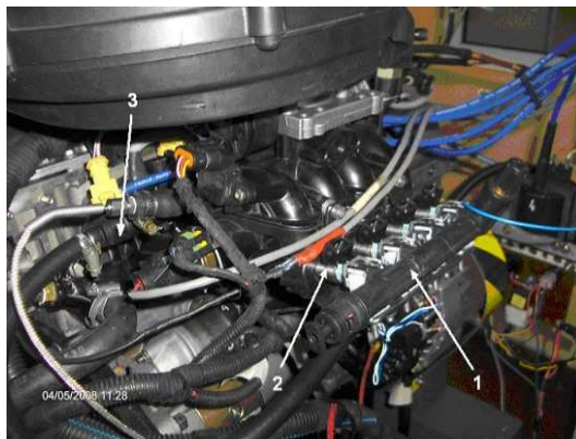
Fig. 4. Widok stanowiska badawczego: 1 – prototypowa szyna paliwowa, 2 – wtryskiwacz dodatkowy, 3 – oryginalna szyna paliwowa
