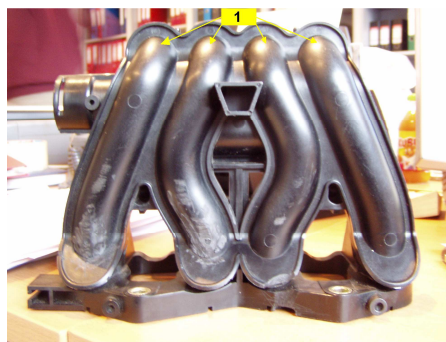
Rys. 3. Oryginalny kolektor dolotowy silnika Fiat 1100: 1 - miejsce usytuowania dodatkowych wtryskiwaczy
