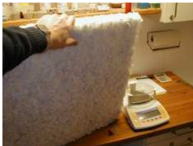
Fot.2. Materiał izolacyjny otrzymany z recyklingu kompozytów
