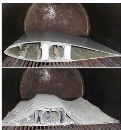
Fot. 1. Łopata wiatrowej turbiny przed i po pirolizie
