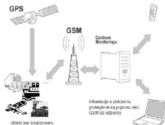
Rys.6. Schemat poglądowy systemu monitorującego
