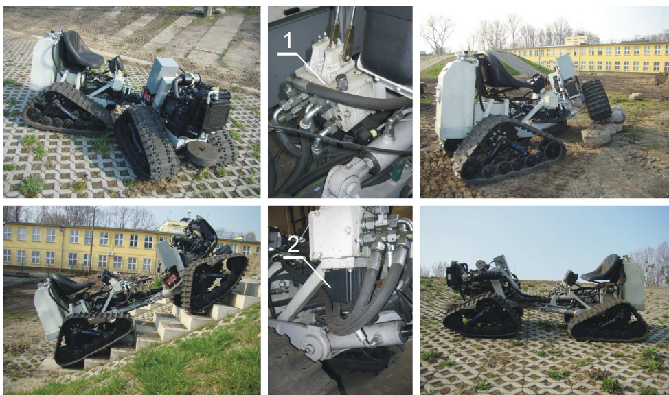
Rys.3. Bezzałogowa platforma lądowa sterowana w oparciu o magistralę CAN: 1 – rozdzielacz hydrauliczny, 2 – elektroniczne moduły CAN-bus
