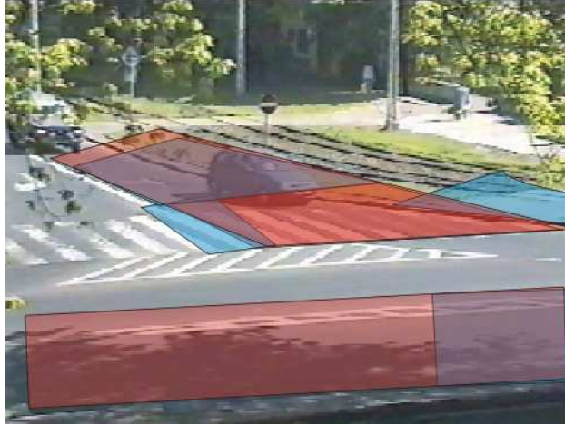
Rys. 5. Obraz z kamery z nałożonymi wirtualnymi strefami kontroli.
