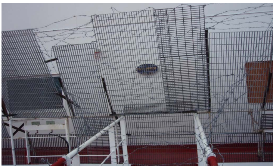
Rys. 5. Dodatkowe zabezpieczenie mające utrudnić przejście statku przez piratów
