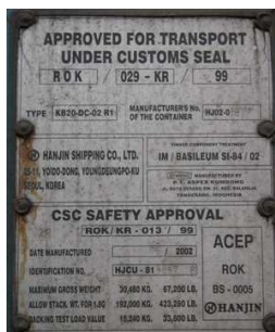
Rys.11. Tabliczka znamionowa kontenera pokryta produktami korozji
