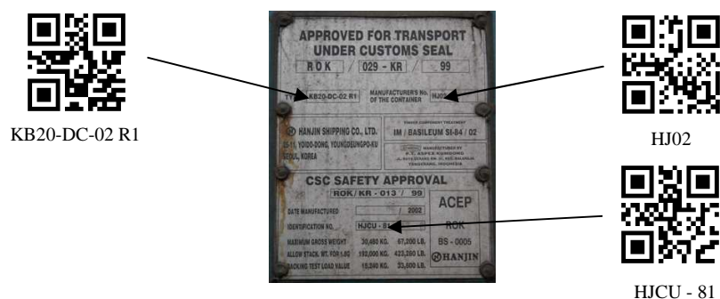
Rys.12. Koncepcja rozmieszczenia elementów kodu QR na tabliczce znamionowej kontenera
