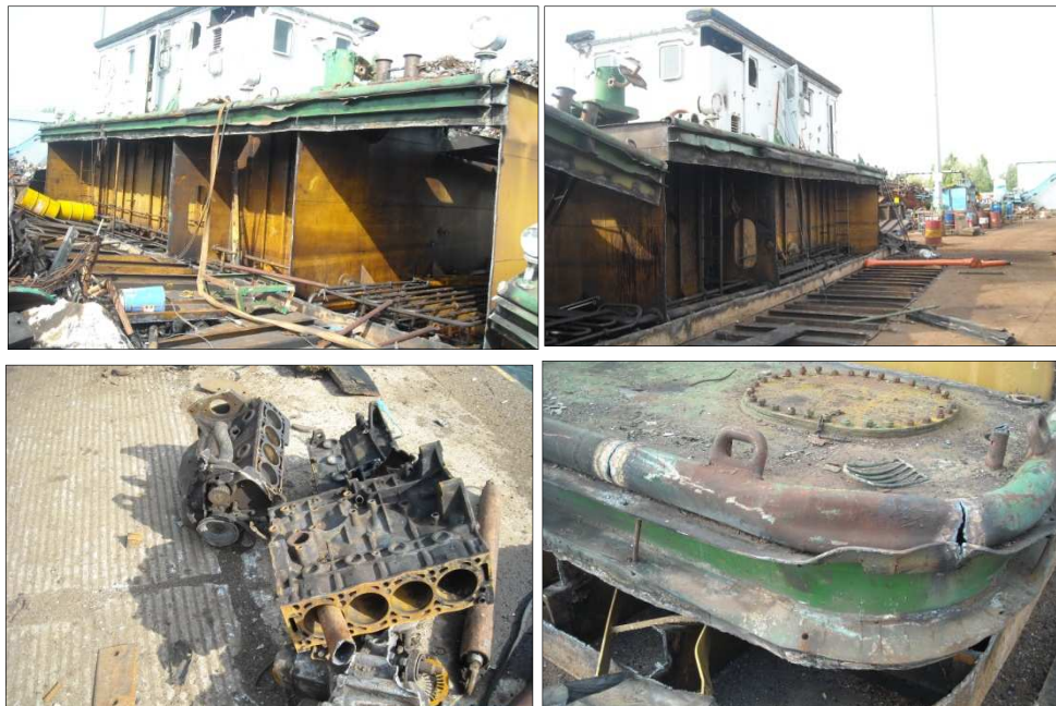
Rys. 6. Statek żeglugi śródlądowej w trakcie złomowania
