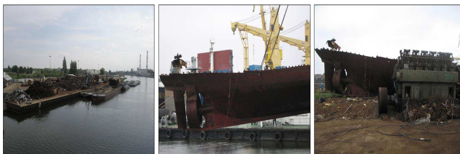
Rys. 5. Statek żeglugi śródlądowej w trakcie złomowania
