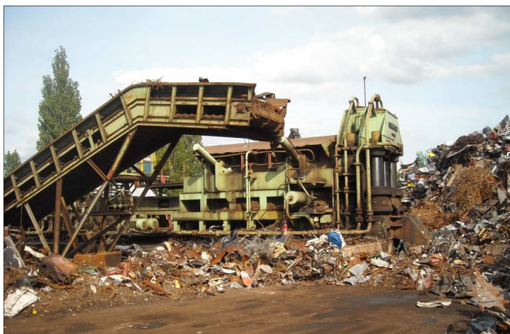
Rys. 7. Urządzenie niszcząco-zgniatające oraz taśmociąg w firmie złomującej małe statki [Fot. własna autora]
