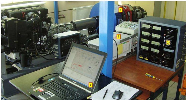
Rys. 6. Widok: 1 - komputera z oprogramowaniem Control Desk, 2 - zespołu sterująco-pomiarowego, 3 - platformy dSpace oraz 4 - stanowiska badawczego
